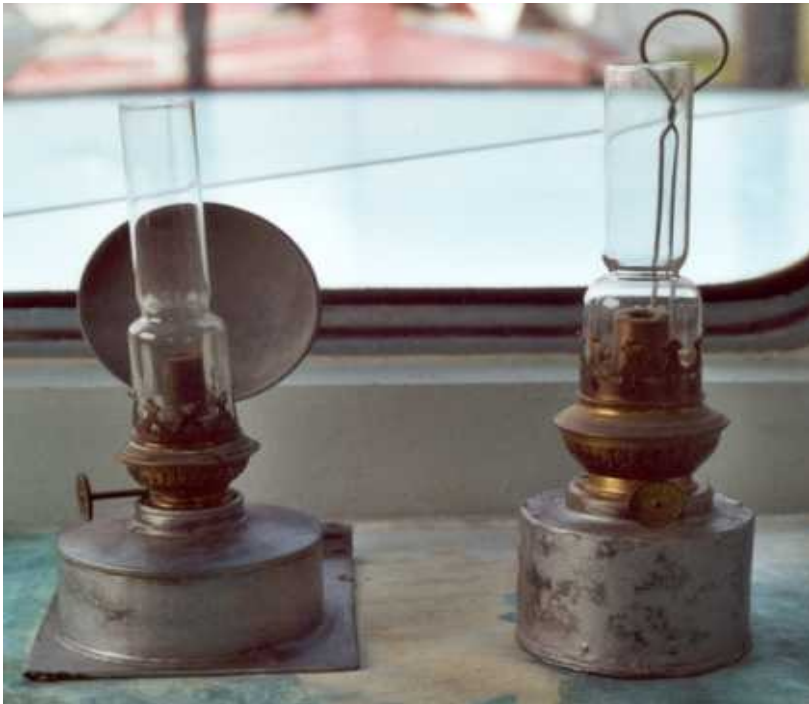
Navigatielichten op basis van olielampen
